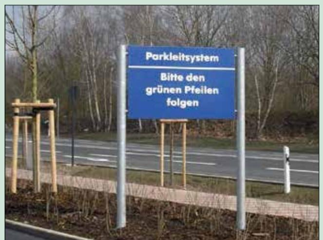
Hinweisschild 1.000 x 500 mm mit verzinkter Stahl-Unterkonstruktion
